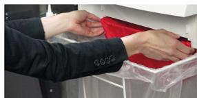
Die Nutzung eines separaten Auffangbeutels ermöglicht die sortenreine Trennung des Schnittguts.
