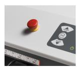
Bei Betätigung des Not-Aus-Schalters wird das Gerät sofort gestoppt.
